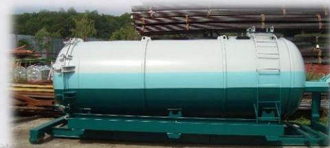
Corp cilindric, fabricat din otel de 6 mm și 8 mm, rezistent la fenomenul de vacuum și presiune, cu capacul din spate actionat manual pentru deschidere.
