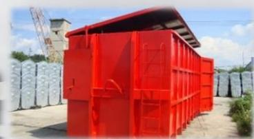
Capacul se deschide cu ajutorul unei pompe hidraulice actionata manual; este destinat depozitarii si transportului de deseuri in siguranta si protejate.
